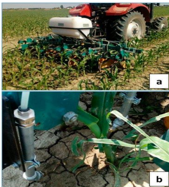
ภาพที่ 1 การพ่นสารกำจัดวัชพืชหลังออกระหว่างแถวปลูก วิธีการนี้จะมีการพ่นสารกำจัดวัชพืชหลังออกด้วยหัวฉีดแบบเฉียง 2 หัวฉีดพ่นได้รัศมี 37.5 เซนติเมตร มี 4 ชุด พ่นได้ครั้งละ 4 แถว วิธีการนี้จะพ่นสารเคมีประมาณ 50% ของพื้นที่บนแถวปลูก (T1)
