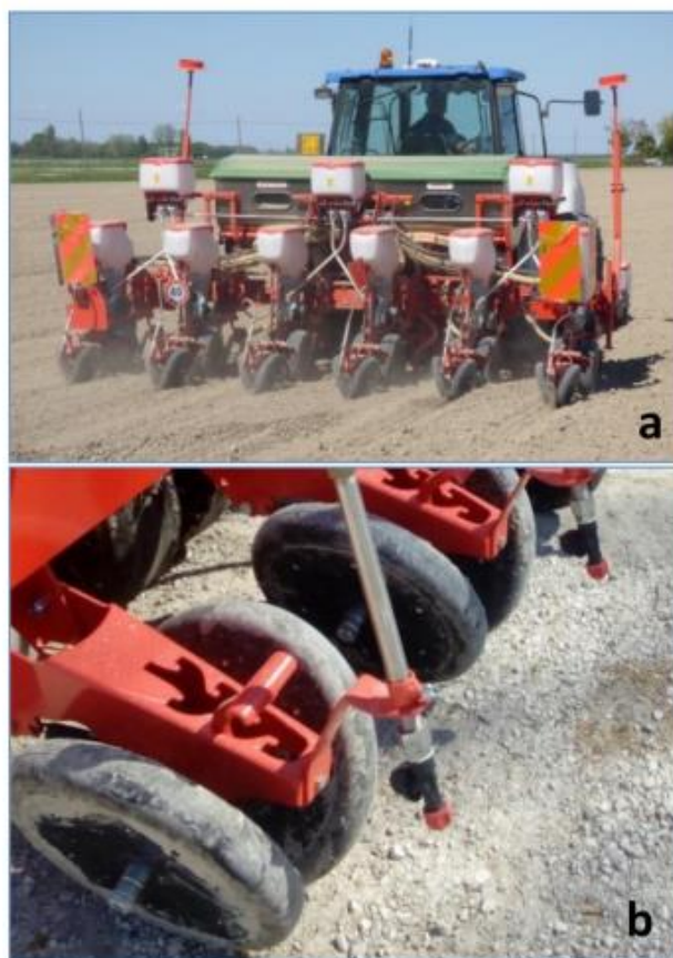
ภาพที่ 2 การฉีดพ่นสารกำจัดวัชพืชร่อนอกด้วยทางรถไฟหัวฉีด 6 หัวฉีด แต่ละหัวฉีดมีรัศมี 25 เซนติเมตร (1 หัวฉีด 1 แถว ได้ครั้งละ 6 แถว) วิธีการนี้จะมีการพ่นสารกำจัดวัชพืชหลังปลูกประมาณ 33% ของพื้นที่ (T2)
